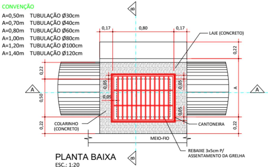
As paredes serão de alvenaria de tijolo maciço, com espessura 22 centímetros, assentadas e rebocadas com argamassa de cimento, cal hidratada e areia média traço 1:2:8 respectivamente, a caixa coletora será somente rebocada internamente.
