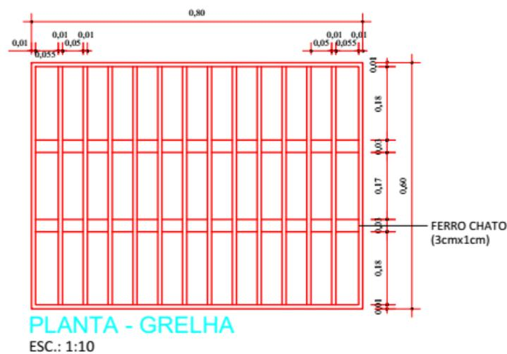
Deverá ser previsto um colarinho de concreto com espessura de 10 cm, e a colocação da grade de ferro na alvenaria com uma cantoneira em ferro conforme detalhe apresentado.
